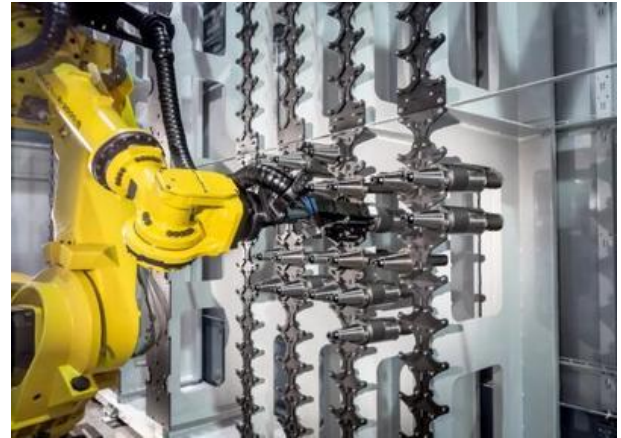
图2 机器人辅助薄壁零件智能化加工场景
