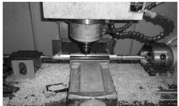
图1 薄壁零件数控铣削加工现场
