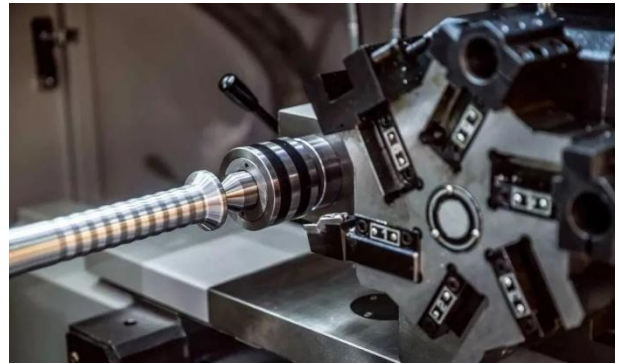
图2 数控车床细长轴车削加工过程
