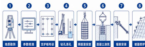
图1 深基坑支护施工优化流程图
