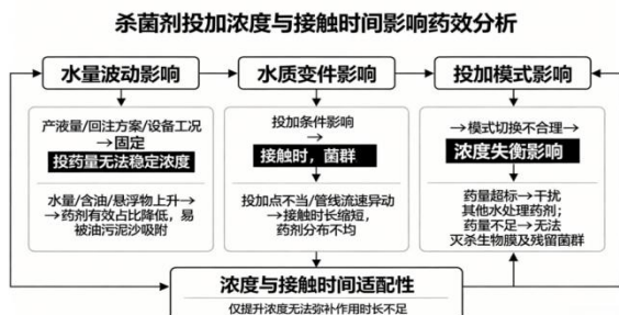
图 2 浓度和接触时间控制不稳定
