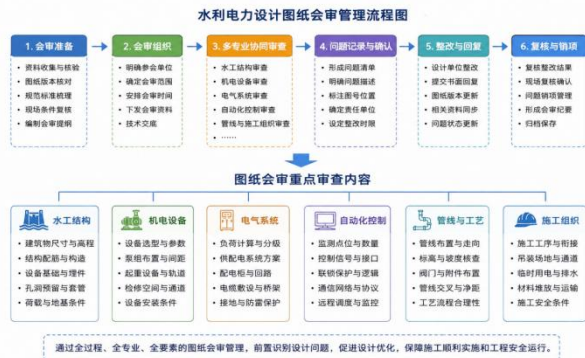
图1 水利电力设计图纸会审管理流程及重点审查内容
