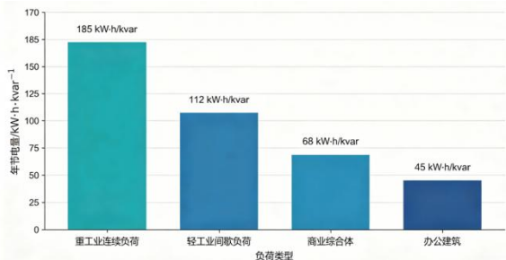
图 2 不同负荷类型单位容量无功补偿的节电敏感性对比
