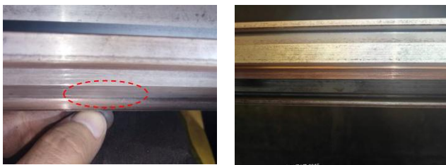
图4 接触线边角处理前、处理后对比
