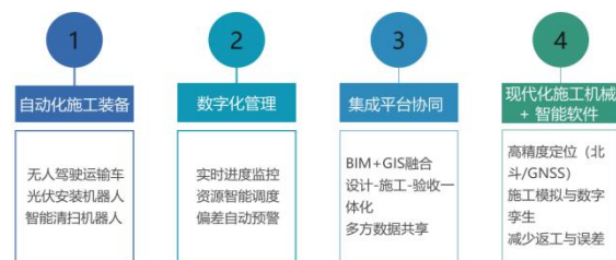
图 1 复杂环境下光伏项目施工效率提升的技术图
