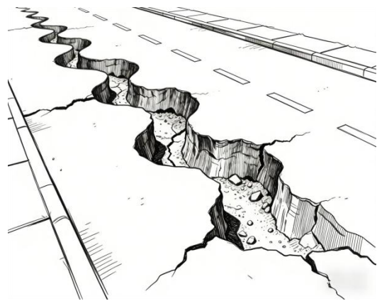
图1 市政道路路基沉降裂缝示意图
