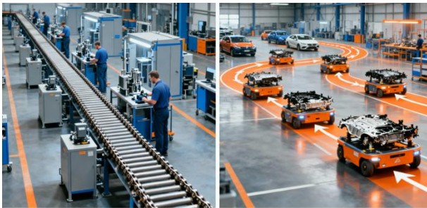
•左图为刚性链式输送带，工位固定；右图为AGV柔性合装系统，AGV可自由路径行变，灵活适配不同车型混线生产。
