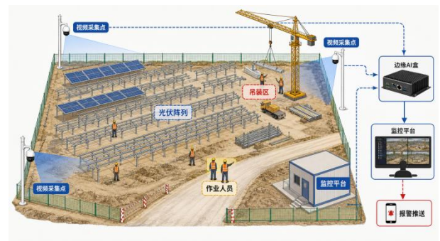
图 1 光伏电站施工 AI 视频识别监控布点
