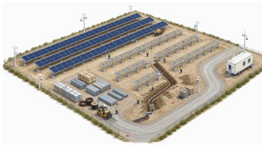
图1 集中式光伏电站建设场区对象关系
