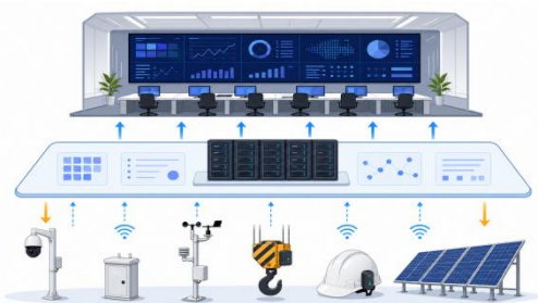
图2 智慧工地系统分层架构
