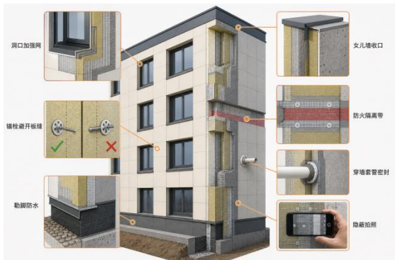
图2 保温层细部隐蔽节点巡检部位
