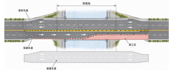
图2 道路桥梁改扩建分幅施工组织示意
