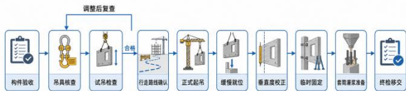
图2 预制构件吊装流程控制节点
