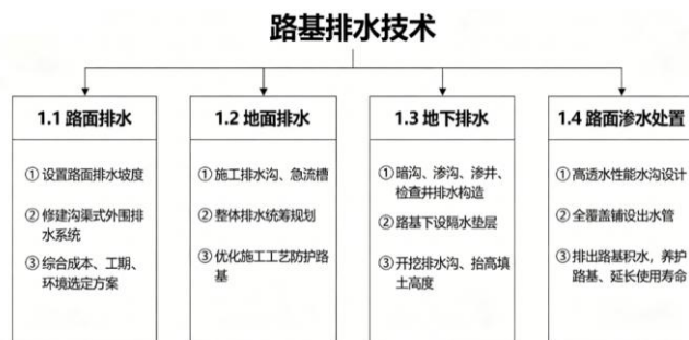
图1 路基排水施工技术流程
