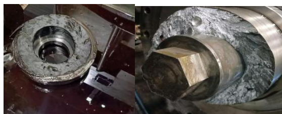
图 6 卷筒主轴尾端断裂
