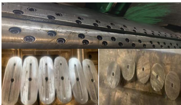
图 5 升降块、导向轴磨损、钳口板断裂
