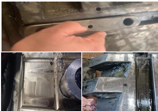
图 3.4 棱锥磨损、扇形块磨损、导向键卡阻
