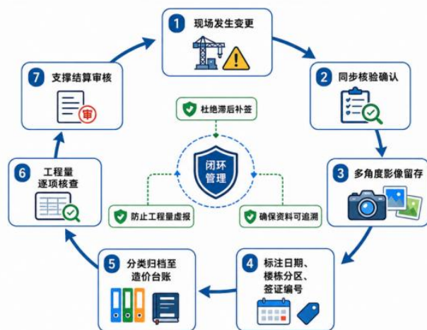
图1 施工阶段签证即时确认与影像留存闭环管理流程图
