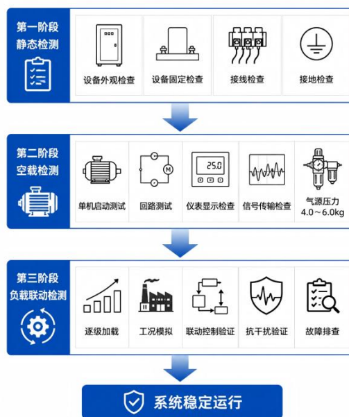
图1 电气自动化控制系统分步检测流程图
