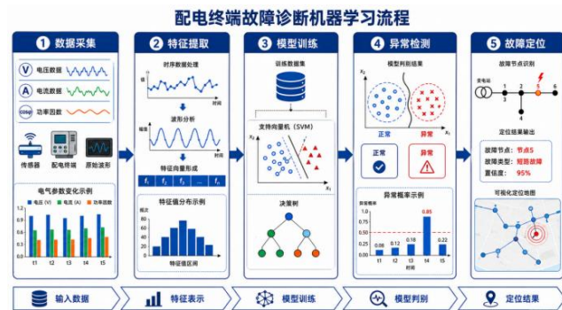
图1 配电终端故障诊断机器学习流程
