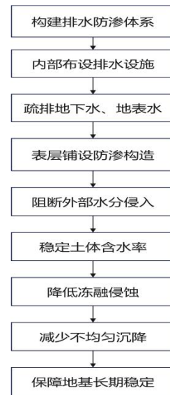
图1 季节性冻土地区地基排水防渗体系实施流程图
