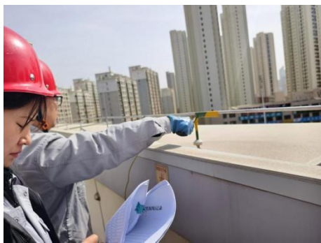
图2 引下线材质复核校验
