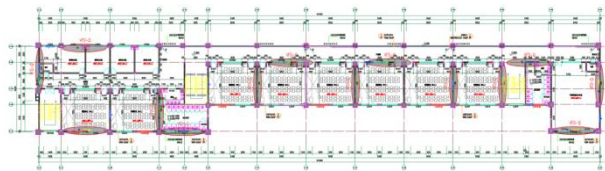
图 6 标准层黏滞阻尼器方案布置图
