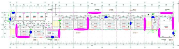
图 8 混合减震方案布置图
