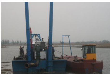
图2 环保机械——绞吸式清淤船河道疏浚
