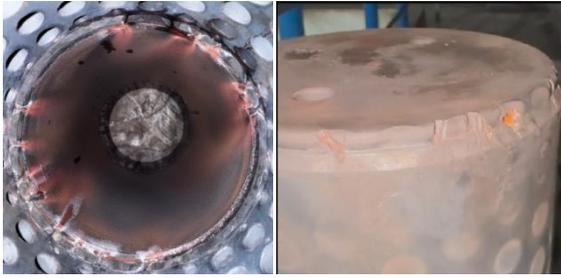
图4 阀座密封面(左图)和阀芯密封面(右图)
