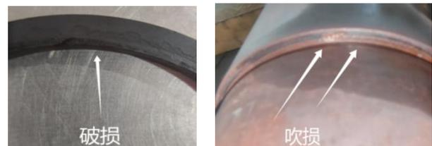
图3 垫圈（左图）和阀杆密封面（右图）
