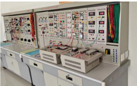
图1 电力系统自动化综合试验台，电力自动化和继电保护设备
