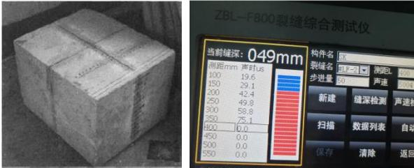
图3 预制带裂缝的混凝土构件模型 (图左)
