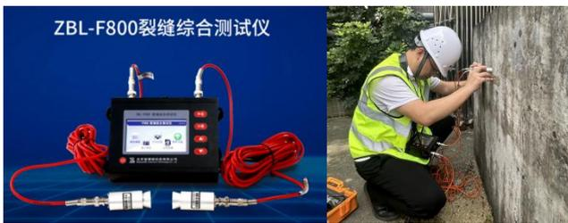
图5 智博联ZBL-F800裂缝综合测试仪及操作
