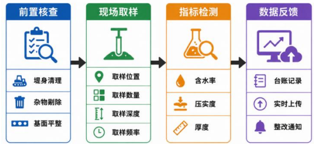
图 1：堤防加高培厚填筑施工监理检测标准化作业流程
