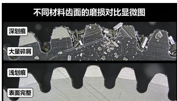
图3 不同材料齿面的磨损对比显微图
