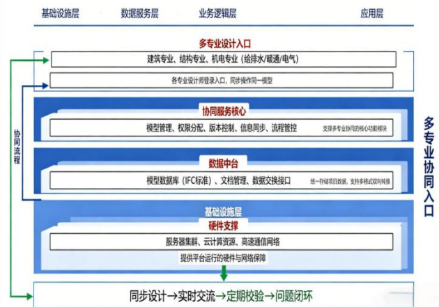
图 1：BIM 多专业协同设计平台架构示意图
