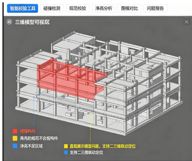
图 2: BIM 模型三维可视化与智能校验操作界面示意图
