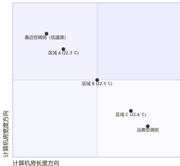
图4 优化后机房温度场分布云图(显示温度分布均匀,无高温热点)
