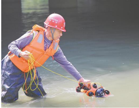
图2 工作人员正在用水下机器人进行检测
